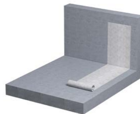
1. Монтаж подстилающего слоя геотекстиля.
